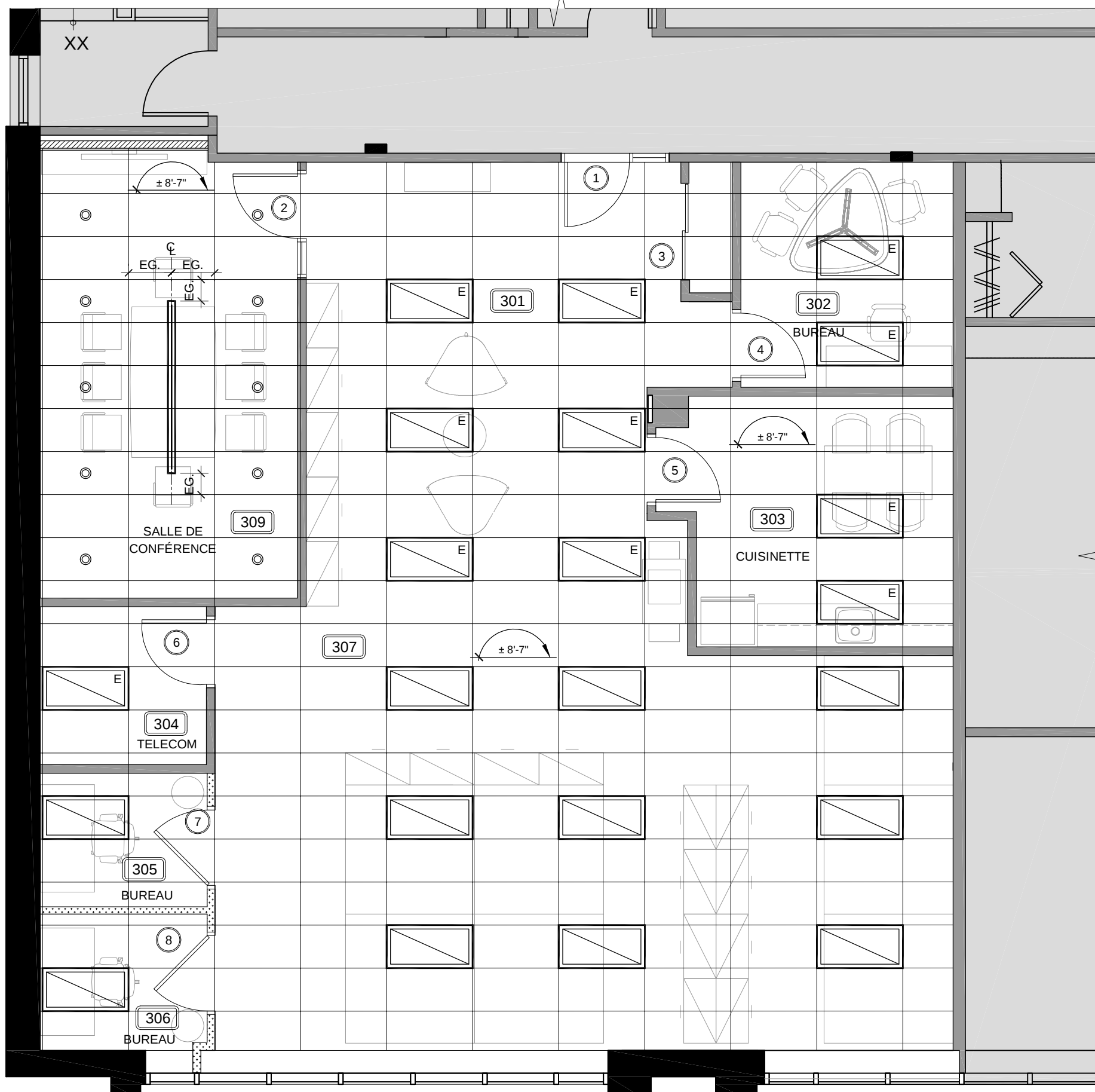
PLAN DU PLAFOND RÉFLÉCHI SCALE / ÉCHELLE: 3/16" = 1'-0"
